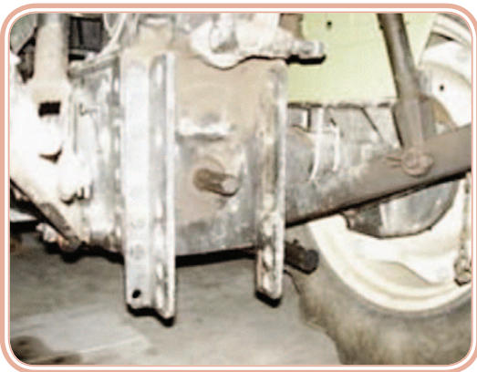
Figura 2.9: Localização da tomada de potência nos tratores agrícolas
