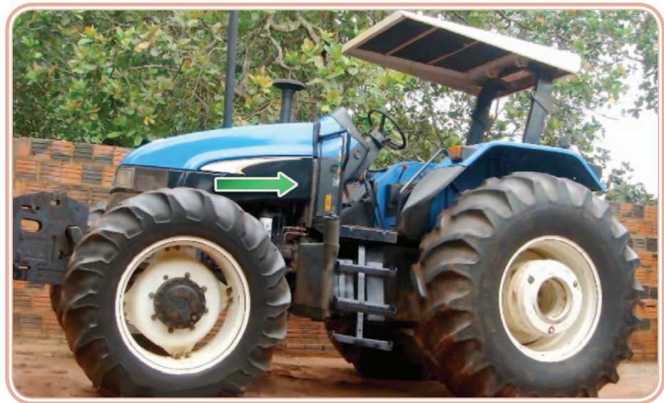
Figura 2.13: Localização das alças e estribos nos tratores agrícolas
